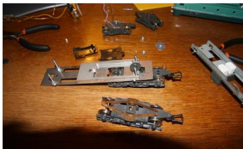
Remplacement des bogies court par les bogies long ... Du coup je vais profiter de l'excellente prise de courant de cette machine pour utiliser le dispositif Jouef
