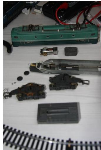
Démontage pour nettoyage du bogie prise de courant, qui est également moteur (la machine à deux bogies moteurs ... Du coup j'ai supprimé la traction pour n'en garder qu'un). Nettoyage avec de l'essence F ou « eau écarlate »
